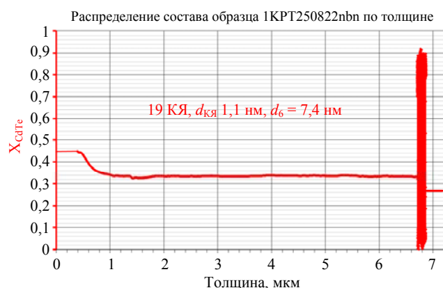
б) n\text{Вn} -гетероструктура на основе ГЭС КРТ МЛЭ со сверхрешеткой в качестве барьера
