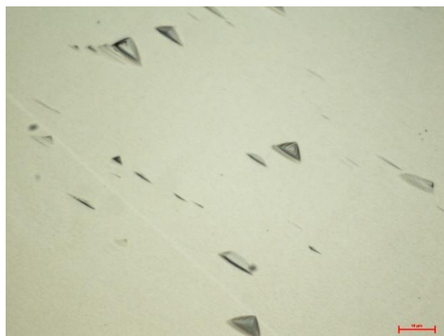
Рис. 10. Типичный вид дислокационной картины монокристаллической области пластины CdZnTe 211(В) после селективного травления
