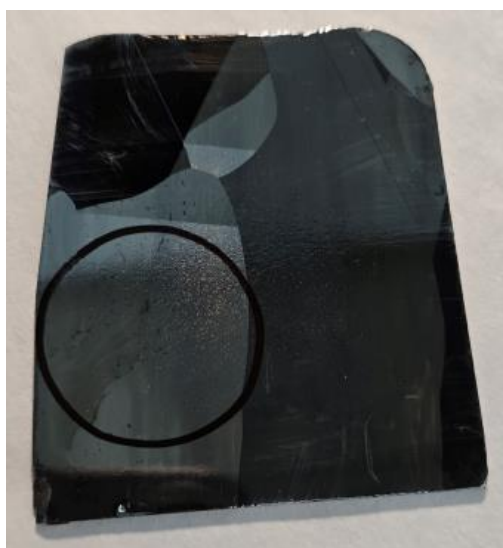
Рис. 9. Внешний вид пластины CdZnTe 211(В) после селективного травления. Контуром выделена монокристаллическая область на стороне В участка отрезанной пластины
