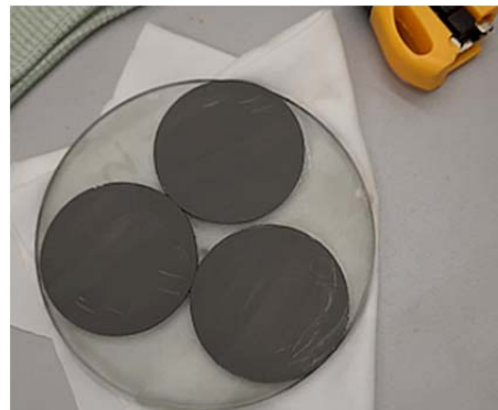
Рис. 2. Иллюстрация решения двумерной задачи упаковки для диска-носителя диаметром 112 мм и пластин InSb диаметром 50,8 мм (а) и фото приклеенных на диск-носитель пластин InSb (б)
