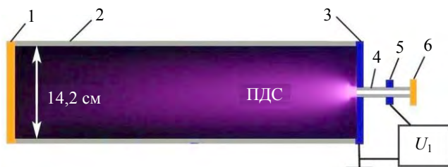
Рис. 1. Схема экспериментальной установки №1 с вставленной фотографией свечения плазменной диффузной струи (ПДС), полученной при давлении воздуха 0,4 Торр и экспозиции 0,25 с. 1 и 6 – фланцы из капролона; 2 – трубка из поликарбоната ESALUX TX с внешним диаметром 15 см и толщиной стенки 4 мм; 3 – заземлённый электрод из дюралюминия с отверстием для кварцевой трубки 4 с внешним диаметром 21 мм и толщиной стенки 1,5 мм; 5 – внешний кольцевой электрод из стальной фольги шириной 10 мм; U_1 – импульсный генератор с амплитудой импульса напряжения на нагрузке U = +7 кВ и частотой f = 21 кГц., подключённый к электродам 3 и 5
