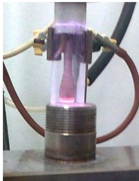
Рис. 1. Схема газотрансформатора с неудобообтекаемым телом – конусом-завихрителем (а) и его опытный образец в эксперименте с подачей порошка (б)
