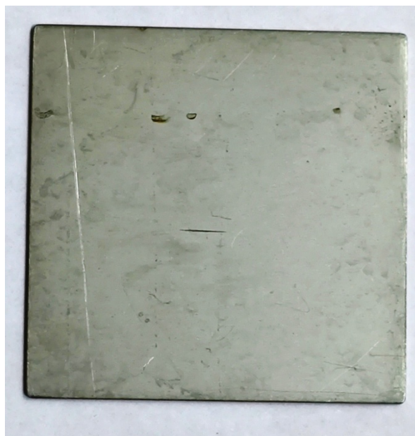
Рис. 3. Фото поверхности образцов после экспонирования на микологической площадке в Ханое
