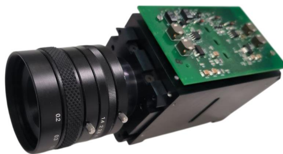
Рис. 8. Внешний вид фотоприемного оптико-телевизионного канала АИ ОТС ПВ на основе модуля типа «ФПМ-5-1»
