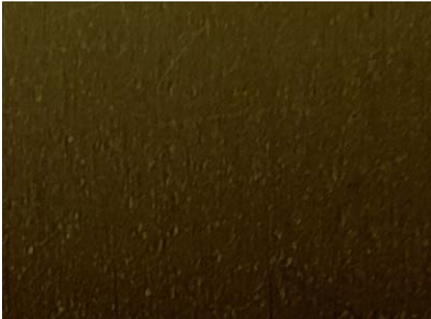
Рис. 3. Поверхность образца с нанесенным слоем ДУ ЛЦУ + Li после испытаний. Не наблюдается рост грибов. Увеличение – \times 10
