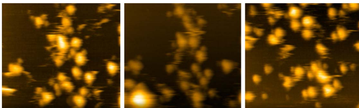
Рис. 2. АСМ-изображения макромолекул BM3 в жидкости, последовательно полученные на высокоскоростном АСМ. Время на кадр 1 с. Область сканирования 200 \times 200 \text{ нм} . Шкала высот от 0 до 4,5 нм. Кадры получены в моменты времени 0 с (слева), 23 с (в центре) и 60 с (справа)
