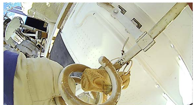
Рис. 3. Хлопчатобумажный сверток ткани, закреплённый на окрашенной внешней поверхности служебного модуля РС МКС
