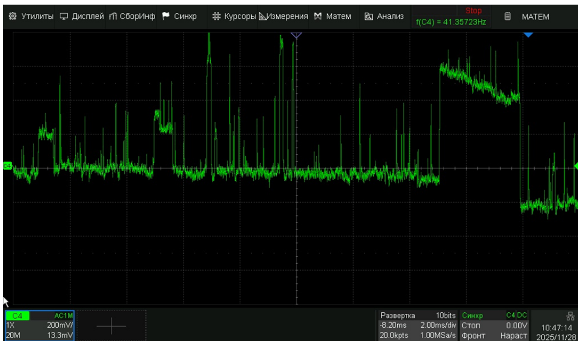
Рис. 4. Осциллограммы напряжения шума при напряжениях 1 В и 10 В
