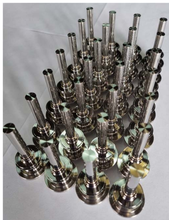
Рис. 3. Внешний вид гильз-держателей серийного выпуска
