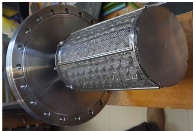
Рис. 1. Опытный образец насоса-картриджа на основе таблеток из Ti-Zr-Al.
