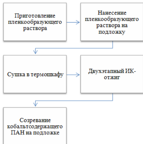
Рис. 1. Схема синтеза тонких пленок кобальтсодержащего ПАН.
