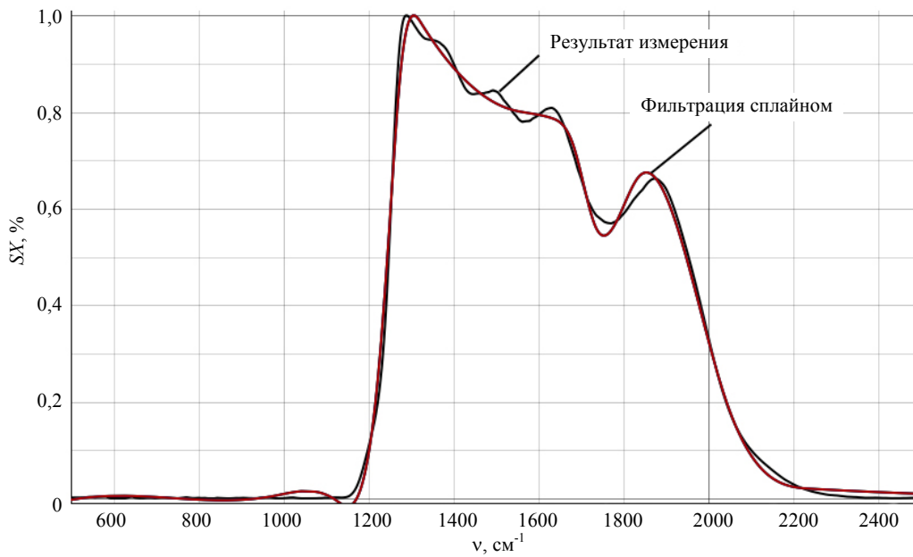
Рис. 2. Реализация интерполяции сплайном для спектральной характеристики образца пятиэлементного фотоприемного устройства.
