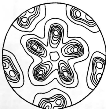
Рис. 4. Температурное поле трубной доски при противоположном движении источников в смежных секторах
