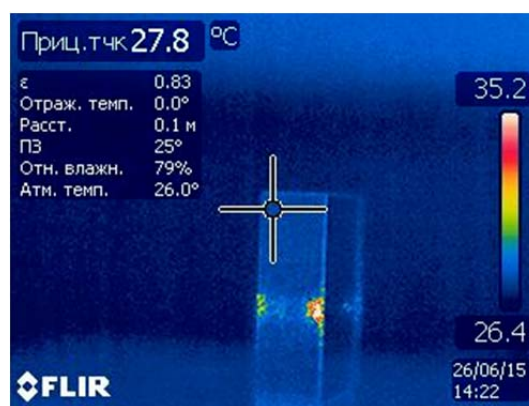
Рис. 2. Тепловизионное изображение образца монокристаллического германия n -типа с наблюдаемыми в нём дефектами. Параметры лазерного излучения: частота повторения 300 Гц, длительность импульса 100 мкс, средняя мощность 550 мВт.
