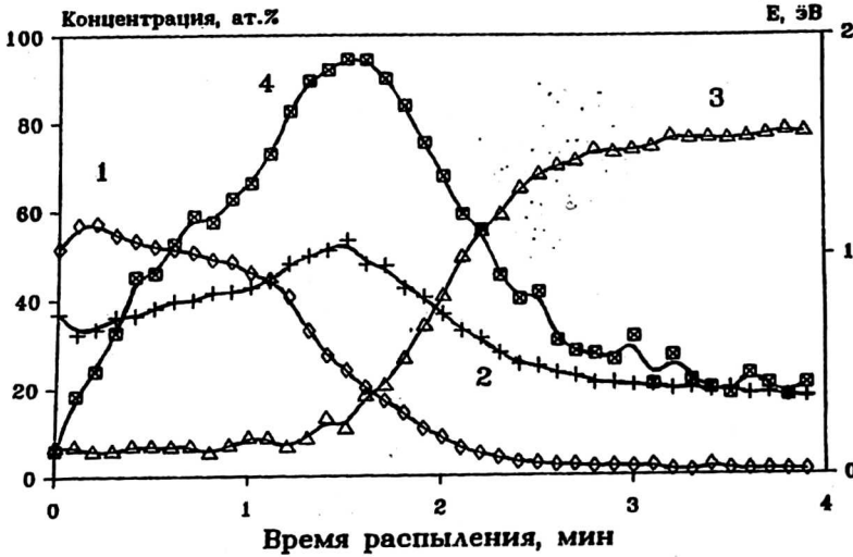
Рис. 5. Атомные концентрации хлора, палладия и кремния в зависимости от времени облучения ионами \text{Ag}^+ : 1 — хлора; 2 — палладия; 3 — кремния; 4 — кривая сдвига оже-пика палладия
