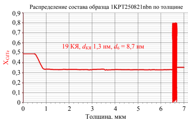
а) n\text{Вn} -гетероструктура на основе ГЭС КРТ МЛЭ со сверхрешеткой в качестве барьера
