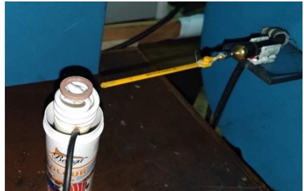
Рис. 1. Фотография системы диэлектрическое кольцо на спиральной лампе. Справа расположен зонд магнитного поля
