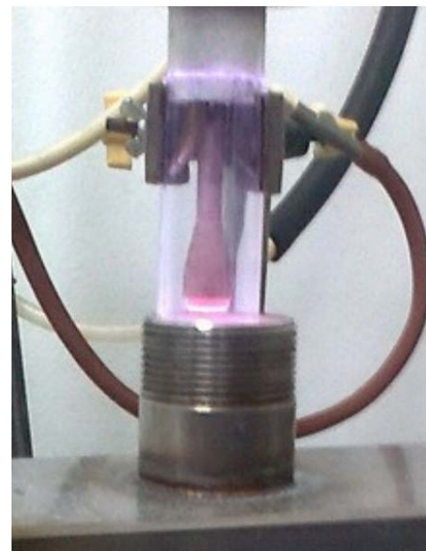
Рис. 1. Схема газоформователя с неудобообтекаемым телом – конусом-завихрителем (а) и его опытный образец в эксперименте с подачей порошка (б)
