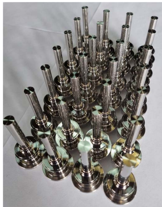
Рис. 3. Внешний вид гильз-держателей серийного выпуска
