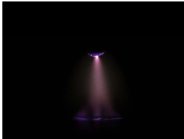
Рис. 1. Фотография разряда с жидким катодом. Разрядный промежуток 4 мм, разрядный ток 60 мА. Раствор нитрата натрия с электропроводностью 300 мкСм/см и pH = 4,7
