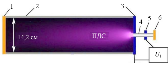
Рис. 1. Схема экспериментальной установки №1 с вставленной фотографией свечения плазменной диффузной струи (ПДС), полученной при давлении воздуха 0,4 Торр и экспозиции 0,25 с. 1 и 6 – фланцы из капрлона; 2 – трубка из поликарбоната ESALUX TX с внешним диаметром 15 см и толщиной стенки 4 мм; 3 – заземлённый электрод из дюралюминия с отверстием для кварцевой трубки 4 с внешним диаметром 21 мм и толщиной стенки 1,5 мм; 5 – внешний кольцевой электрод из стальной фольги шириной 10 мм; U_1 – импульсный генератор с амплитудой импульса напряжения на нагрузке U = +7 кВ и частотой f = 21 кГц, подключённый к электродам 3 и 5
