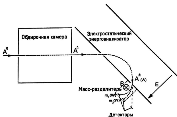
Рис. 3. Схема диагностической системы для измерения энергетических спектров атомов перезарядки
