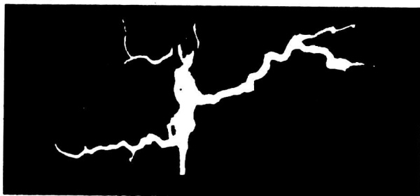
Рис. 4. Формирование плазмоидных структур при атмосферном давлении при организации подачи воздуха (газа) в область факела
