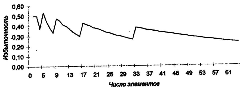
Рис. 2. График зависимости избыточности табличного способа представления от количества элементов перестановки
