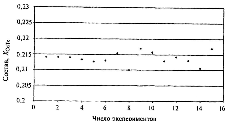
Рис. 5. Воспроизводимость состава КРТ в ряде последовательных опытов: среднее значение состава X_{CdTe} = 0,2137 , \Delta X_{CdTe} = 0,002 , \Delta X_{CdTe} / X_{CdTe} = 93 \%
