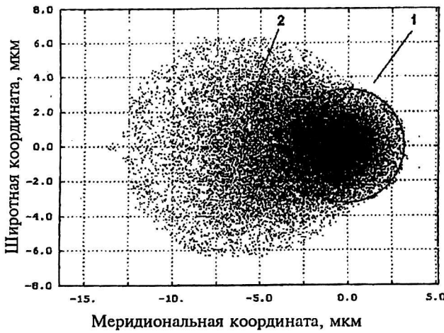
Рис. 4. Влияние нарушения осевой симметрии анодной диафрагмы на фигуру рассеяния точки в центре фотокатода (изображения совмещены): 1 — возмущение геометрии отсутствует; 2 — диафрагма повернута на угол 10^\circ относительно оси, проходящей через центр катода и перпендикулярной оси симметрии
