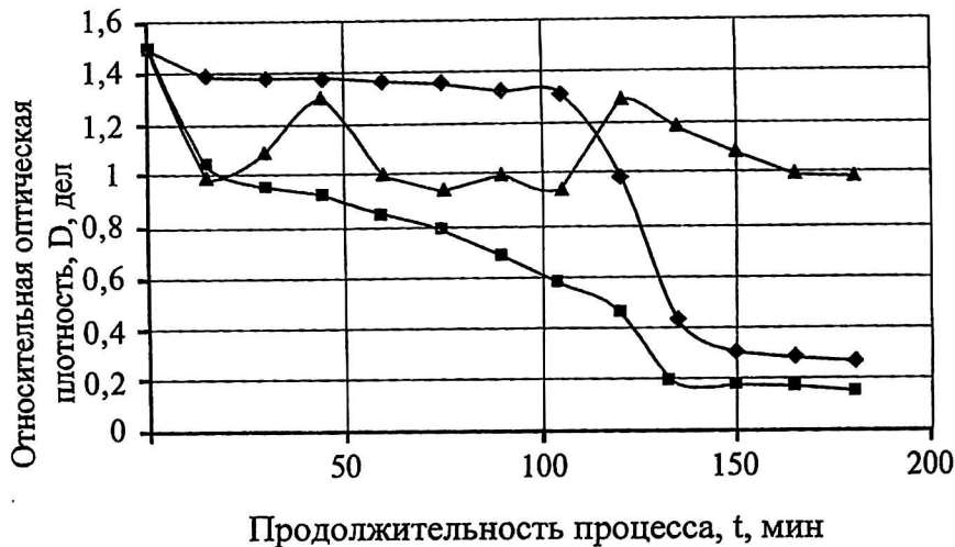
Рис. 3. График зависимости оптической плотности красильных ванн от продолжительности процесса крашения: —◆— — контрольный образец; —■— — опытный образец после 3-минутной обработки; —▲— — опытный образец после 5-минутной обработки
