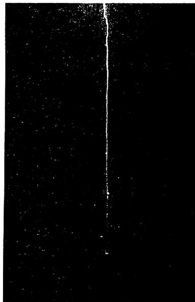
Рис. 4. Фотография поверхностного микроволнового пробоя (в форме контрагированного разряда) на диэлектрическом кристалле КВг. Вектор электрического поля падающего микроволнового излучения параллелен каналу пробоя. Размеры кристалла 70×10×5 мм
