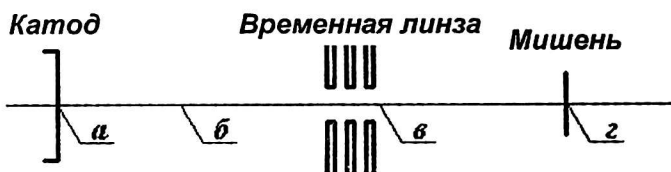
Рис. 4. Принципиальная схема электронно-оптической системы с тонкой временной линзой: a, b, c — точки, для которых на рис. 5 приведены фазовые диаграммы
