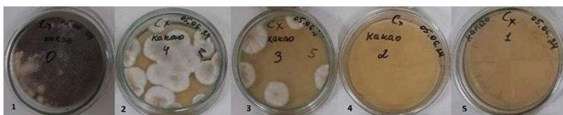
Рис. 2. Действие микроволнового излучения на плесневые грибы: 1 – контроль; 2 – 10 мин; 3 – 15 мин; 4 – 20 мин; 5 – 25 мин экспозиции
