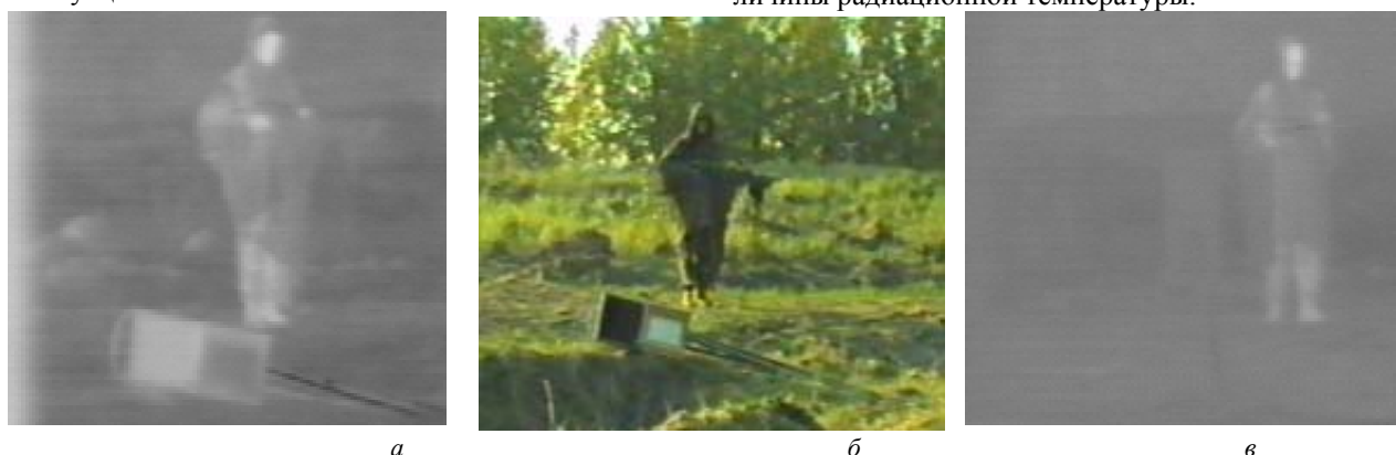
Рис. 1. Тепловизионные (а, в) и телевизионное (б) изображения ситуации № 1, диапазон 7,6—11,8 мкм: а — 18 ч 16 мин; б — 18 ч 16 мин; в — 02 ч 11 мин
