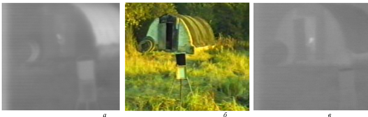
Рис. 2. Тепловизионные (а, в) и телевизионное (б) изображения ситуации № 5, диапазон 7,6—11,8 мкм: а — 10 ч 17 мин; б — 10 ч 17 мин; в — 02 ч 24 мин
