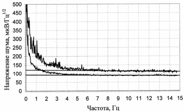
Рис. 4. Спектральное распределение шума напряжения ГФМС при напряжении на затворе согласующего транзистора dU_{com} = -1,16 В (нижняя кривая) и dU_{com} = -1,18 В (верхняя кривая)
