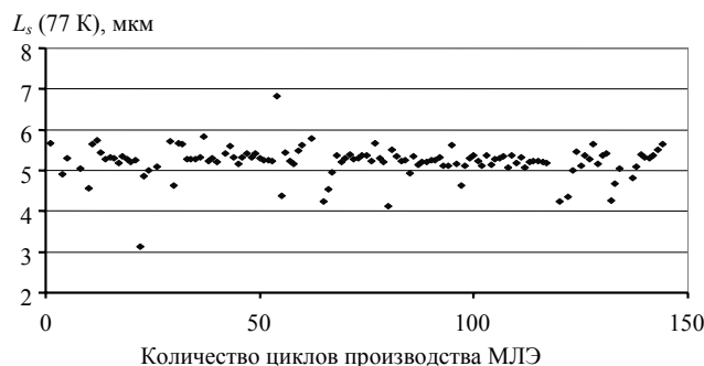
Рис. 3. Дисперсия значения правой граничной длины волны при 77 К, измеренной более чем по 100 3-дюймовым слоям КРТ на подложке из Ge
