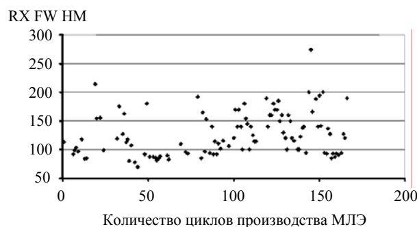
Рис. 2. Дисперсия среднего значения угла FWHM для 3-дюймовой CdTe/Ge-поверхности в зависимости от количества циклов производственного процесса МЛЭ
