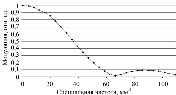
Рис. 12. Измерение значения MTF-пикселя
