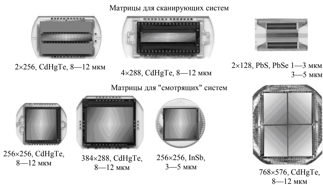
Рис. 8. Фоточувствительные элементы матричных ФПУ
