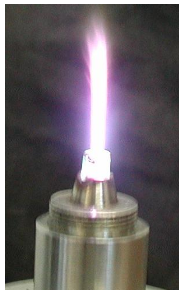
Рис. 2. Фотография СВЧ-факела в потоке аргона (5 л/мин), истекающего в атмосферу. (Высота факела 25 мм. Свечение вокруг яркого ядра — возбужденный азот)
