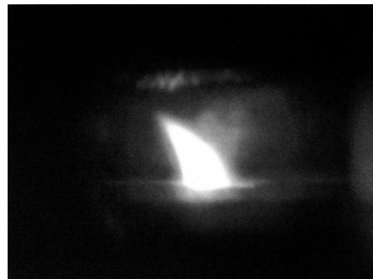
Рис. 5. Поток аргоновой плазмы, отклоняемый поперечным потоком технологического газа
