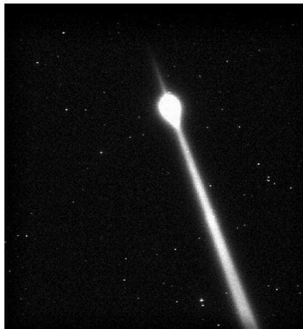
Рис. 1. Эксперимент по распространению частотно-модулированного импульса лазерного импульса мощностью 5 ТВт, \lambda = 800 \text{ нм} в атмосфере. Высота вспышки в области фокусировки 9 км [1]
