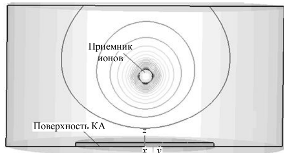
Рис. 4. Эквипотенциальные поверхности электростатического поля, образованного между мишенью и приемником
