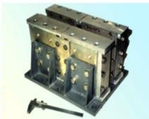
Рис. 8. Бесконтактное тормозное устройство для аттракциона "Баиня свободного падения" на ПМ
