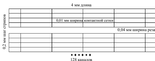
Рис. 2. Топология многоэлементного фотоприемника
