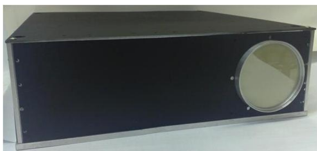
Рис. 2. Внешний вид двухдиапазонной тепловизионной системы для спектральных диапазонов 3—5 и 8—12 мкм
