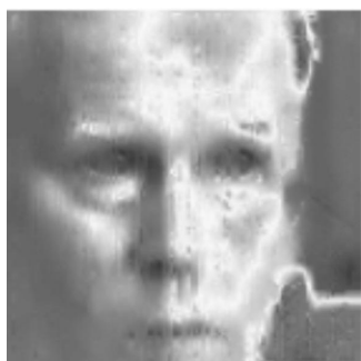
Рис. 10. Тепловизионное изображение, полученное с помощью МФПУ
