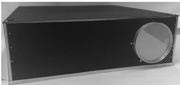
Рис. 1. Внешний вид двухдиапазонной тепловизионной системы для спектральных диапазонов 3—5 и 8—12 мкм
