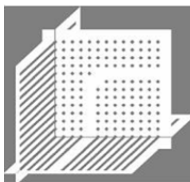
Рис. 1. Двухмерный волновод в моделируемом пространстве фотонного кристалла. Диэлектрическая проницаемость цилиндров \epsilon = 11 , диаметр 0,4a
