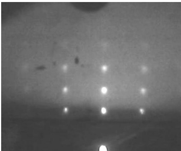
Рис. 1. Электронограмма эпитаксиальной пленки Pb_{1-x}Sn_xSe ( x = 0,07 )
