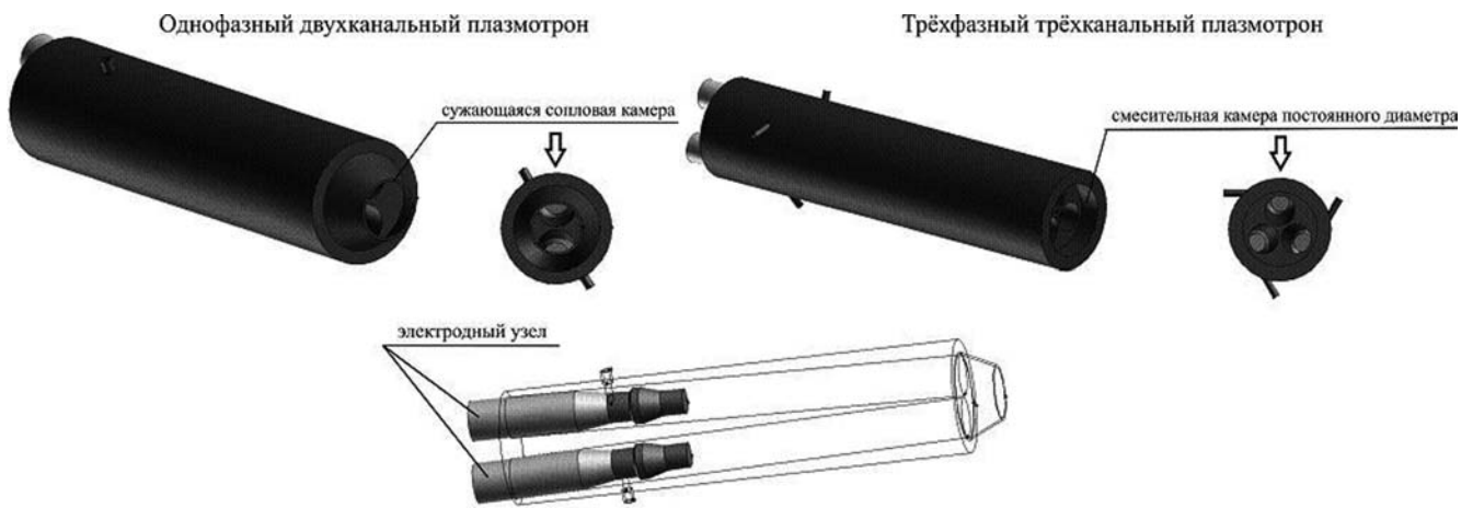
Рис. 1. Высоковольтные плазмотроны переменного тока с электродными узлами.
