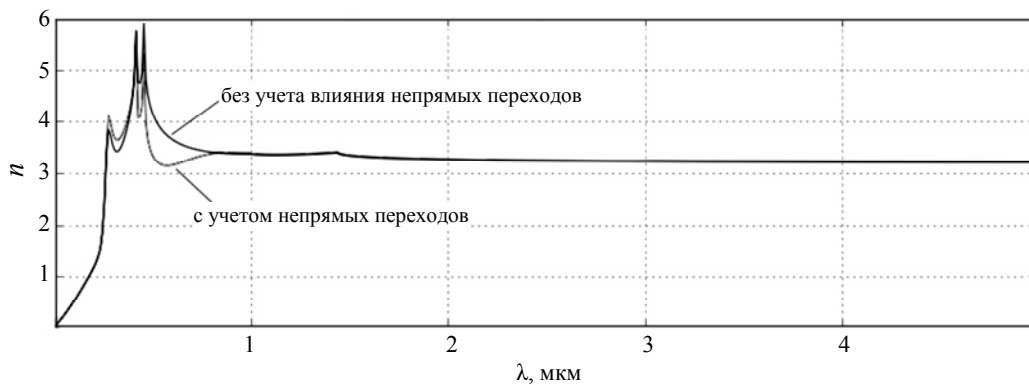
Рис. 5. Сравнение зависимостей показателя преломления InGaAs с учетом и без учета влияния не прямых \Gamma -L и \Gamma -X переходов.
