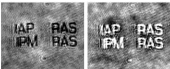
Рис. 4. Прямое и инвертированное микроизображение названия места работы сотрудников. Размер букв 30 мкм.
