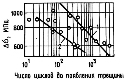
Рис. 6. Термическая усталость сплава ВКНА-4У с монокристаллической (1) и направленной (2) структурами при температуре цикла 373—1373 К
