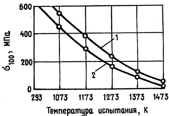
Рис. 5. Длительная прочность сплава ВКНА-4У с монокристаллической (1) и направленной (2) структурами в зависимости от температуры
